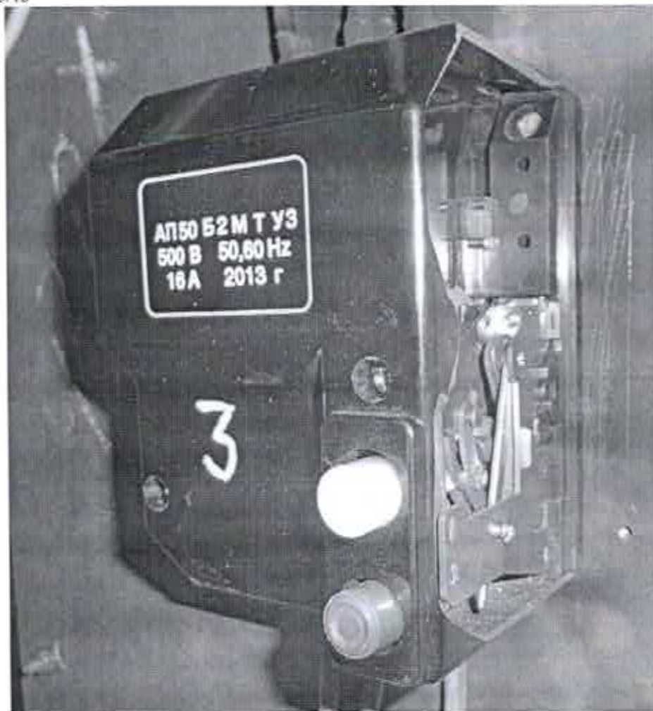
Рис. 7 – Образец № 3 после ПКС, вырвало боковую стенку крышки
