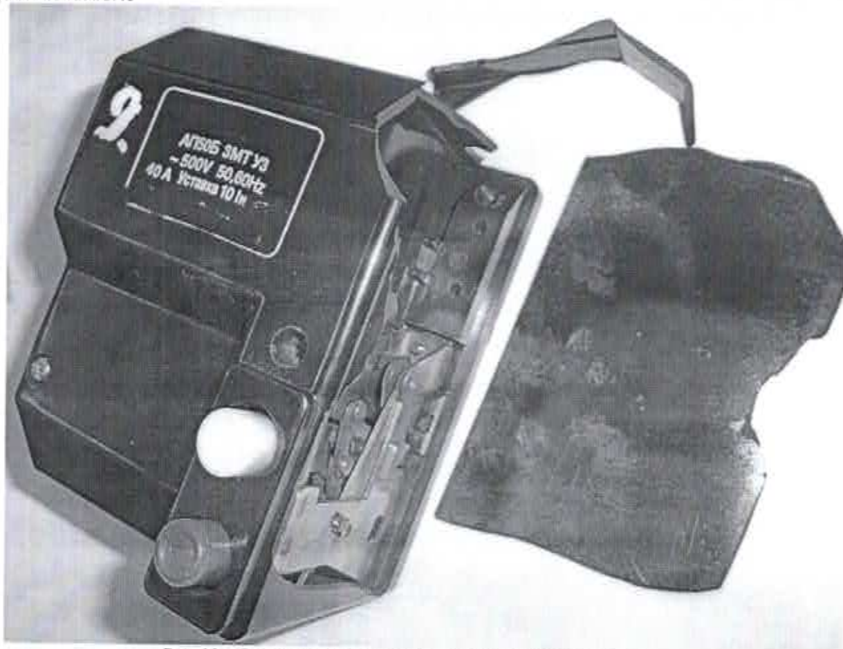
Рис. 13 – Образец № 9 после ПКС, вырвало боковую стенку крышки
