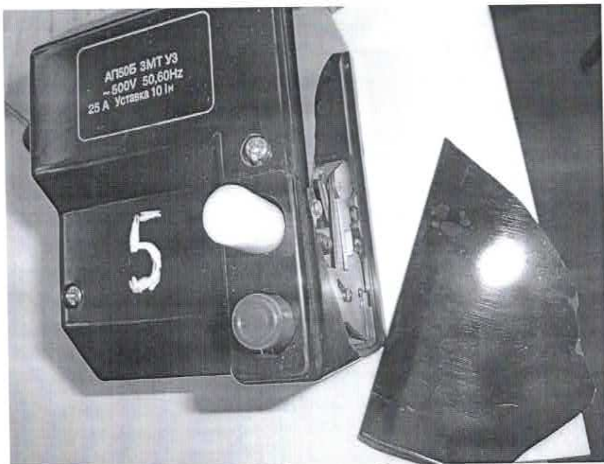
Рис. 9 – Образец № 5 после ПКС, вырвало часть боковой стенки крышки
